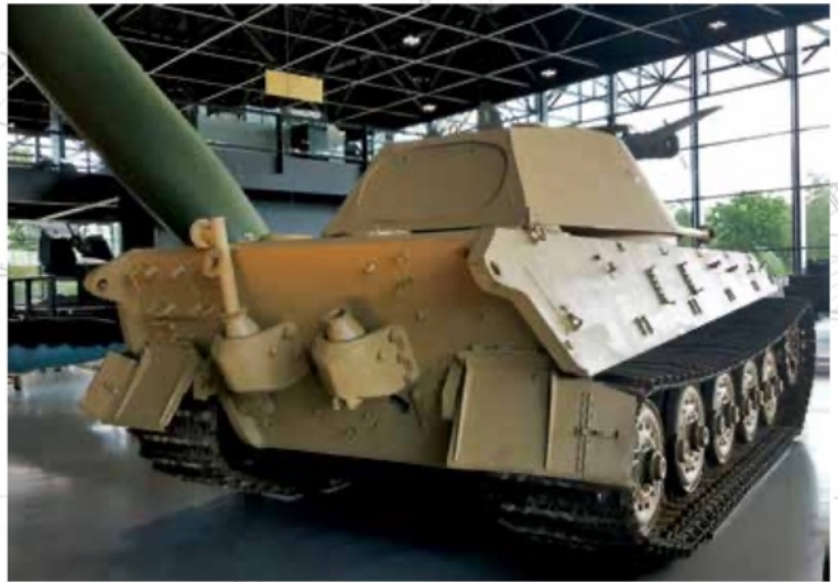
Het houten paneel en aangepaste uitlaat aan de achterzijde van de koepel
